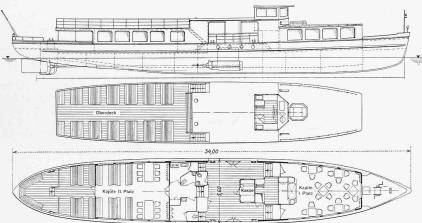
Abb. 1. Motorschiff «Arenenberg» der «Schweiz. Schiffahrtsgesellschaft Untersee und Rhein». Abb. 2. Ansicht und Deckpläne 1:300. — Länge ü. A. 34,0 m, Breite im Hauptspant 5,60 m. Tiefgang beladen 1,35 m, Verdrängung 98 m³ bei 250 Personen.
