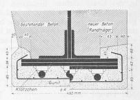
Abb. 2. Münchensteiner-Strassenbrücke über den Bahnhof Basel. Hauptträger-Querschnitt 1:10.
