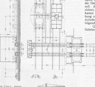
Abb. 2 bis 4. Anlage zum Herstellen und Zuwasserlassen der Eisenbetonsenkkasten; Grundriss und Schnitte, Masstab 1:600.
