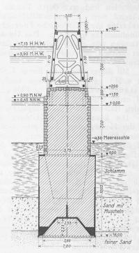
Abb. 1. Querschnitt durch die Mole (Caissons 22 bis 38).
