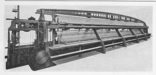
Abb. 1. Saurer-Automat-Schiffchenstickmaschine Modell 2S, für 15 Yards (13,7 m) Sticklänge. Sticklänge, weil zweireihig, zweimal. Nadelzahl bei 4/4" Rapport (= Dessinbreite) 1024, bei 6/4" noch 680 Nadeln; 130 Stiche in der Minute. Länge der Maschine 18,45 m, Höhe 3,35 m, Nettogewicht 14 200 kg.
