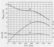
Abb. 12. Einstufige Bohrloch-Axial-pumpe Nr. 50 S. n = 725 U/min.
