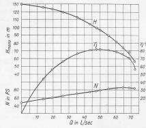
Abb. 9. Zweistufige M-D-Zentrifugal-pumpe Nr. 21-15.  $n=2900~\mathrm{U/min}$ .
