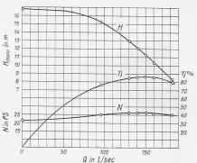
Abb. 10. Schraubenpumpe Nr. 20. n = 1450 U/min.
