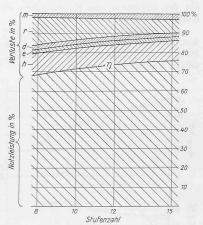
Abb. 7. Wirkungsgrad in Abhängigkeit von der Stufenzahl am Beispiel einer Pumpe für 30 1/sec, 1000 m, 2900 U/min. Verluste: m mechanische, r Radreibung, d Dichtungsringe, e Entlastungsscheibe, h hydraulische,
