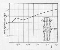
Abb. 5. Reibung einer im Wasser rotierenden Scheibe in Abhängigkeit des Wandabstandes, bei gleichbleibender Temperatur und Drehzahl.
