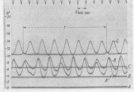
Abb. 1a und b. Oszillogramme der Schwankung des statischen Druckes im ersten Leitrad einer zweistufigen Mitteldruck-Zentrifugalpumpe.
