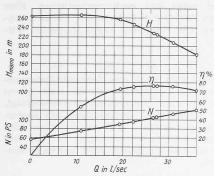
Abb. 8. Vierstufige H-D-Zentrifugal-pumpe Nr. 21e. n = 2900 U/min.
