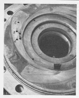
Abb. 2. Korrosionen infolge Kavitation im Leitrad. A, B und C = Messtellen.
