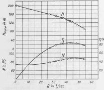
Abb. 11. Zehnstufige Bohrloch-Axial-pumpe Nr. 23 K. n = 1450 U/min.
