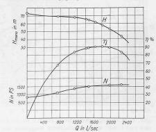
Abb. 13. M-D-Zentrifugalpumpe Nr. 100 df. n = 680 U/min.
