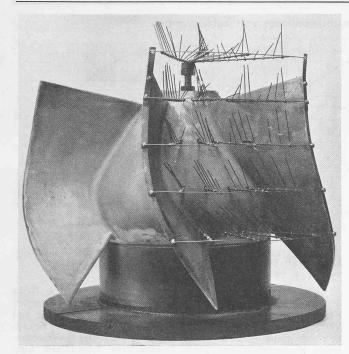
Abb. 4. Geschwindigkeitsverteilung nach Grösse und Richtung im Kanal eines axialen Leitapparates für den normalen Betriebspunkt (bei der Ausführung dieses Modells wurde die Aussenwand weggelassen).
