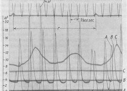
erkennen, dass zwischen den Punkten B und C eine schroffe Umsetzung der kinetischen Energie in Druckenergie stattgefunden hat. nach einigen Stunden Betrieb in diesem Zustande traten die aus
