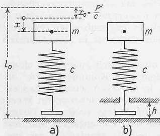
Soll sich die Feder  $c$  von der Unterlage nicht abheben, so muss die durch die konstante Kraft  $P'$  hervorgerufene Zusammendrückung  $x_0$  grösser als der grösste Schwingungsausschlag sein. Dies kann durch Beeinflussung der Eigenfrequenz erreicht werden.
