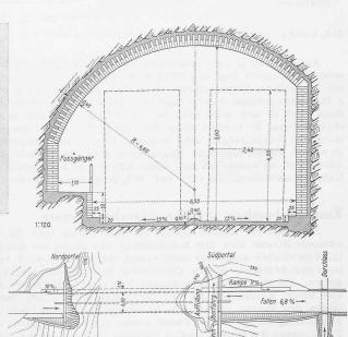
Abb. 2. Tunnel durch das Fuchsfallenhorn. Ausbruchquerschnitt rund 38 m2.
