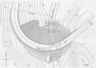
Durchlass von 30 m² durch den Damm im Meerenbachtobel hinter Mühlehorn (Deponie des Ausbruchs aus dem Fuchsfallenhorn-Tunnel).
