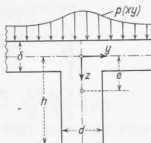
Die dritte Bedingung sagt aus, dass längs des Anschlusses die Plattendurchbiegung mit der Biegungslinie des Balkens übereinstimmen muss, sodass man weiter für
