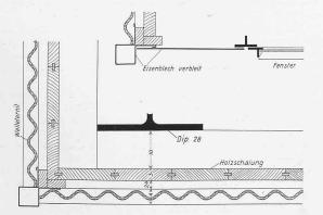
Abb. 10. Horizontalschnittt 1:10, Ecke volle Wand bezw. Fenster.
