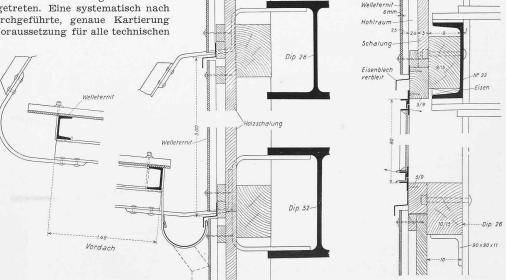
Abb. 9. Einzelheiten zu Abb. 8, Masstab 1:10. Vertikalschnitte durch Vordach, Aussenwand und Fenster.
