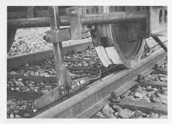
Abb. 2. Bestimmung der Berührungspunkte zwischen Rad und Schiene.
