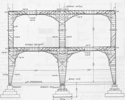
Abb. 14. Eisenbetonrahmen des Neubaues 1933. — Masstab 1:100.
