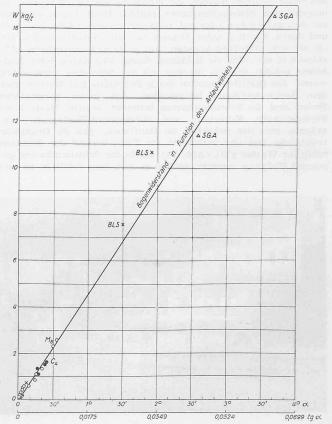
Abb. 5. Bogenwiderstand in Funktion des Anlaufwinkels.
