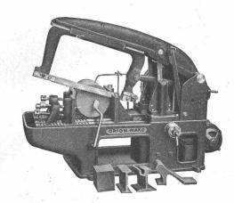
... sind die Orion Hako-Hochleistungs-Sägemaschinen. Die unverwüstliche und betriebssichere hydraulische Steuerung macht aus ihnen die wirtschaftlichste und in der Bedienung einfachste Maschine des Betriebes.
