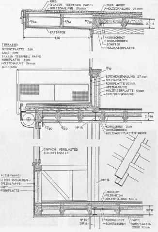
Abb. 6 Konstruktive Einzelheiten. - Masstab 1:30.
