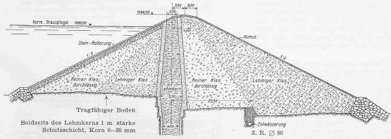
Abb. 4. Grösster Ausführungsquerschnitt des Bannalp-Staudammes. — Masstab 1:600.
