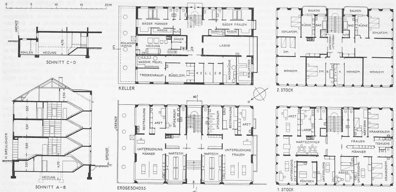
Abb. 3 bis 7. Schnitte und Grundrisse 1 : 400 der medizinischen und dermatologisch-venereologischen Poliklinik Zürich.
