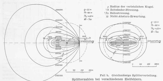
Fall a: Relative Splittergeschwindigkeit = Geschossgeschwindigkeit.
