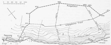
Abb. 5. Lageplan der Verlegung bergeinwärts des Sernfwerk-Druckstollens.  $-1:20\,000.$
