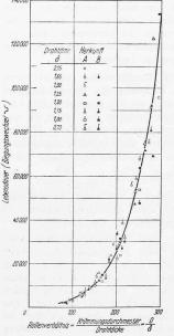
Abb, 1. Lebensdauer von Seildrähten verschiedener Dicke und Herkunft.  $K_z = 130 \text{ kg/mm}^2$ , = 30 kg/mm<sup>2</sup>. Die Punkte sind Mittelwerte] aus je 10 Versuchen.
