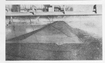
Abb. 6. Wasserdurchflusslinien im Modell-Dammprofil.
