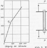
Abb. 4. Längungs-Diagramm d. Verschraubung nach Abb. 3.
