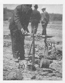
Abb. 10. Verdichtungsmass-Prüfapparat.
