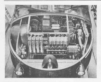
Abb. 8. Geöffneter Vorbau Triebgestell-Seite (II).
