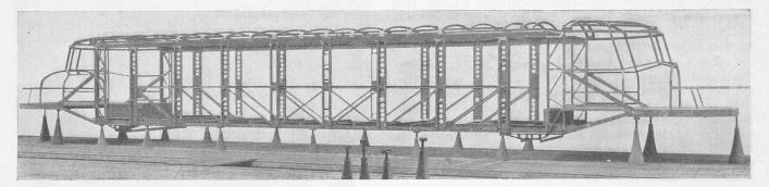
Abb. 6. Stahlgeschweisstes Wagenkastengerippe, als Längsträger von 16,3 m Stützweite. — Schweiz. Lokomotiv- und Maschinenfabrik Winterthur.
