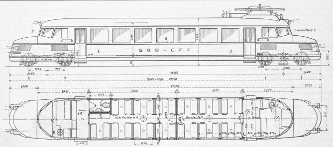
Abb. 2. Elektrischer Leichttriebwagen CLe<sup>2</sup>/4 der SBB. — 70 Sitz-, 30 Stehplätze; Dienstgewicht 32,6 t; Vmax = 125 km/h. — Typenskizze 1:120.
