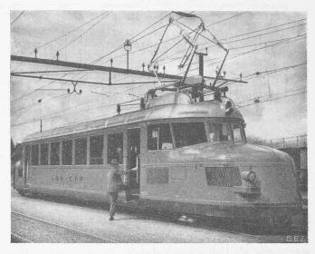
Abb. 1. Elektrischer Leichttriebwagen CLe<sup>2</sup>/<sub>4</sub> der SBB.
