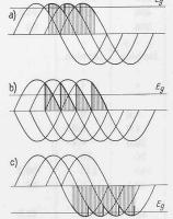
Abb. 1. Prinzip der Gittersteuerung. Dick ausgezogen: Zeitlicher Verlauf der Spannung Kathode-Sternpunkt (schematisch) bei verschiedener Wahl des Zündpunkts a) b) c).
