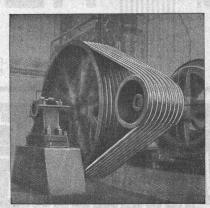
Antrieb eines Kompressors, 125 PS.
