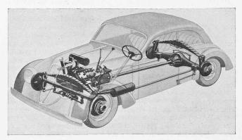
Abb. 2. DKW-Kleinwagen mit Querfederung der vordern und hintern Schwebeachse.
