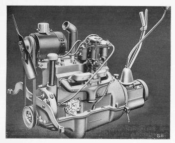
Abb. 4. 1,2 l-Motor des Ford Typ «Eifel».
