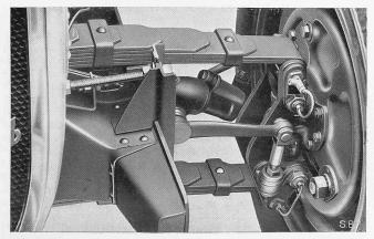
Abb. 5. Hanomag, achslose Aufhängung der Vorderräder.
