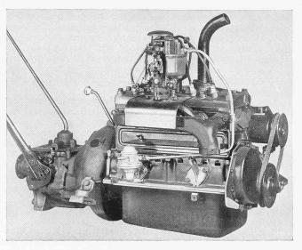
Abb. 6. 1,07 l-Opel-Motor des Typ P4.
