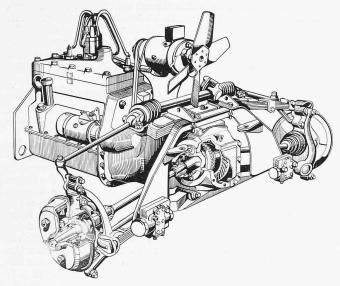
Abb. 1. Motor- und Vorderradantrieb des Adler Trumpf-Junior.
