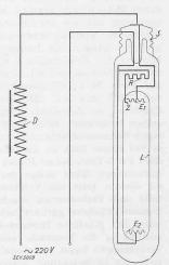
Abb. 4. 275 W-Osram-Queck-silberdampflampe. L Lampe,  $\mathbf{E}_1$ ,  $\mathbf{E}_2$  Hauptelektroden, R Vorschaltwiderstand, Z Zündelektrode, D Drosselspule, S Goliath-Sockel.
