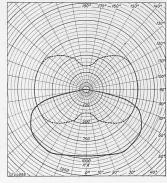
Betriebstemperatur von 300° unabhängig von der Aussentemperatur möglichst rasch erreicht wird, und zur Verminderung der Wärmeverluste, ist über die eigentliche Lampe ein evakuiertes Isolierglas V gestülpt. Abb. 2 gibt die Lichtverteilungskurven in einer Ebene senkrecht zu der horizontalen Röhrenaxe wieder, und zwar sowohl der Lampe allein, wie auch der Lampe mit dem Belmag-Breitstrahler (Abb. 3), mit dem sie in dieser Anlage ausgerüstet ist.
