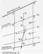
Teil derselben oberhalb, ein anderer Teil unterhalb der Sättigungsoder Sickerlinie. In Abb. 9 ist eine solche Lamelle hervorgehoben. Der obere Teil ABEF liefert nur Vertikalkräfte. Bezeichnet man mit  $\gamma_e^*$ das Raumgewicht des über der Sickerlinie liegenden, mehr oder weniger feuchten Bodens und mit Vi das Volumen des Segmentteils ABEF, so
