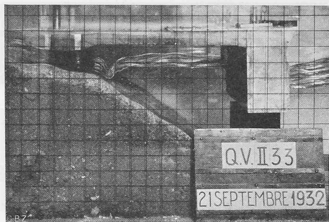
Fig. 17. Modèle à l'échelle 1 : 30 du nouveau quai de Vevey. Vue prise à l'instant où le creux d'une vague atteint la caisse-écran (houle incidente: \lambda = 25 m, h = 1,50 m).
