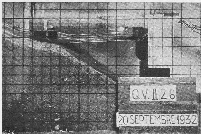
Fig. 16. Modèle à l'échelle 1 : 30 du nouveau quai de Vevey. Vue prise au moment où la crête d'une vague arrive sur la caisse-écran (houle incidente: \lambda = 25 m, h = 1,50 m).
