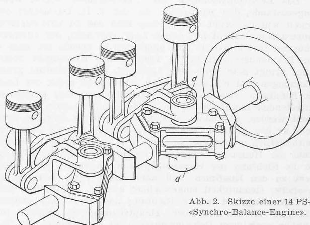
Abb. 2. Skizze einer 14 PS-«Synchro-Balance-Engine».
