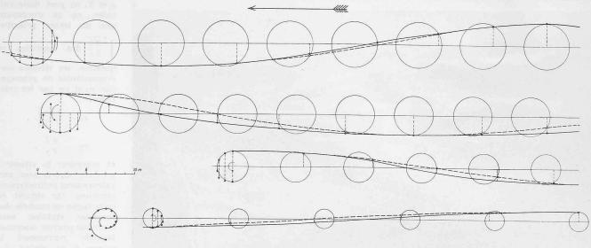
Fig. 7. Comparaison de différents profils de vagues relevées par la photogrammétrie aux trochoïdes passant par les crêtes et les creux. Mise au net de Kohlschütter d'après les observations du «Planet».
