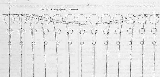
Fig. 1 et 2. Ondes de surface. Solution de Gerstner: le profil est une trochoïde, les trajectoires des particules sont des cercles, le rotationnel est différent de zéro.
