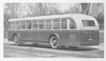
Abb. 4. Yellow Coach-Omnibus, 40 Plätze, mit Heckmotor, nach Abb. 3.
