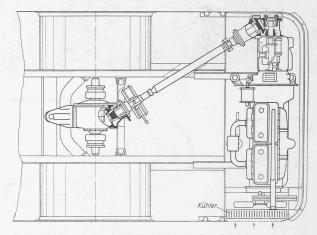
Abb. 3. Anordnung des Heckmotor-Antriebes der 40-plätzigen Yellow-Coach (nach Abb. 4).
