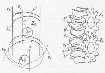
Abb. 4. Herstellung von Satzrädern mit der Forster Fräsmaschine (schematisch).
