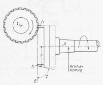
Abb. 2. Herstellungsprinzip der Zahnflanken.
