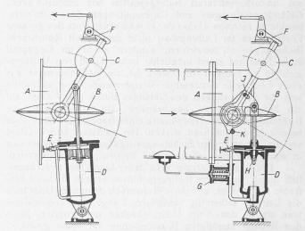
Abb. 5. Automat. Rohrabschluss mit Schliessgewicht alter Bauart.
