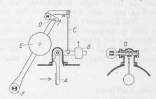
Abb. 8. Hydraul. Auslöseinrichtung alter Bauart. Legende: A Teller, B Belastungsgewicht, C Gestänge, D Klinke, E Fallgewicht, F Klappenwelle, G Dichtung.
