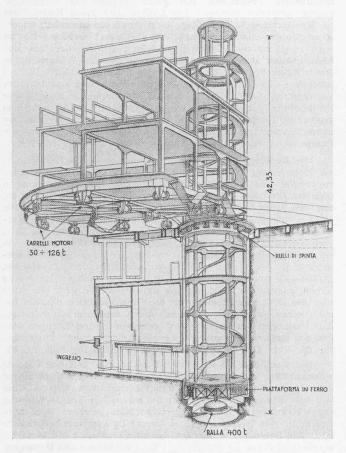
Abb. 3. Isometrie des drehbaren Eisenbetonskelettes samt Unterbau.
