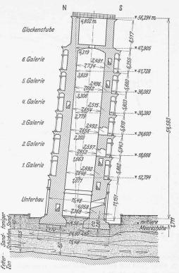
Abb. 1. Schnitt 1:700 durch den Turm.
