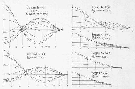
Abb. 19. Statische Berechnung: Einflusslinien der Bogendeformation. Werte  $E \cdot dm'm$  für  $P = 1 \ t.$   $\eta$  in cm.
