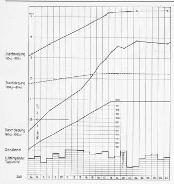
Abb. 14. Mauerdurchbiegung im Scheitelschnitt vom 5. bis 27. Juli 1935.
