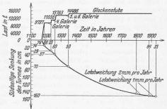
Abb. 2. Zeit-Setzungs-Diagramm des Turmes.
