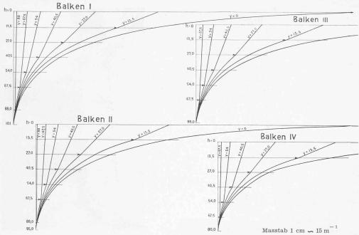
Abb. 20. Statische Berechnung: Einflusslinien der Deformation.  $E imes ext{Balkendurchbiegungen für } P = 1 ext{ t.}$
