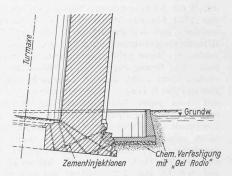
Abb. 3. Schnitt 1:350 durch Turmfuss und «Kragen».
