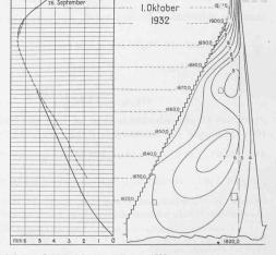
Abb. 15. Scheiteldurchbiegung (voll: Pendel, gestrichelt: Klinometerstab) und Mauertemperaturen 1932.
