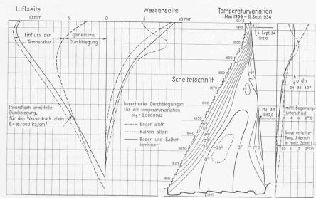
Abb. 22. Scheiteldurchbiegung am 11. September 1934 in Bezug auf den 1. Mai 1934. Ermittlung der Einflüsse der Temperatur und des Wasserdrucks auf Grund der Deformationsbeobachtungen, Vergleich mit der statischen Berechnung.
