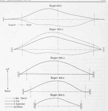
Abb. 17. Charakteristische Bogendeformationen, Mittelwerte der Jahre 1932/34. Abgewickelte Bogenlängen 1:2500, Deformationen 2:1.
