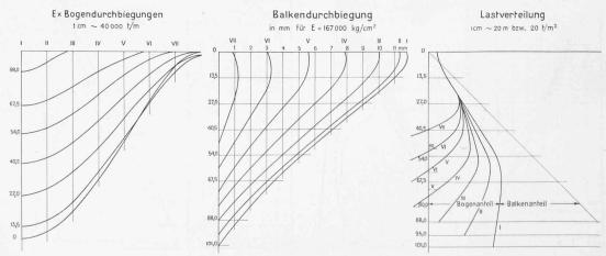
Abb. 21. Statische Berechnung: Gerechnete Durchbiegungen und Verteilung des Wasserdruckes.
