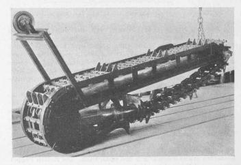
Abb. 2. Wanderrost mit Saugmundstück und in Vierergruppen angeordneten Aufreissern. — Konstruktion L. v. Roll'sche Eisenwerke, Rondez.
