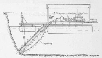
Abb. 1. Schemat. Längsschnitt der «Saug-Rost-Bagger»-Anlage, 1:150.
