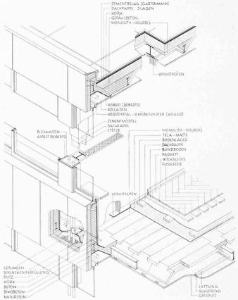
Abb. 17. Einzelheiten der Konstruktion, Isometrie 1:50.
