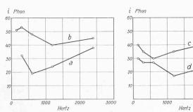
Abb. 16. Isolationswerte verschiedener Bauteile (vergl. den obenstehenden Text) in Funktion der Tonfrequenz.
