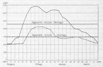
Abb. 12. Durchschnittlicher Tagesverlauf des Schmutzwasseranfalls.
