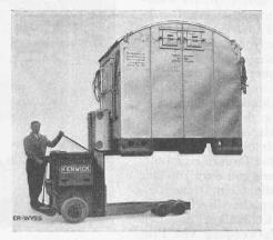
Abb. 2. SICON-Behälter auf elektr. Hubtraktor.
