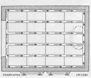
Abb. 1. Schema des SICON-Kühlbehälters. 1 Kühlluft, 2 Stoffbälge, 3 Mundstücke, 4 Eis.
