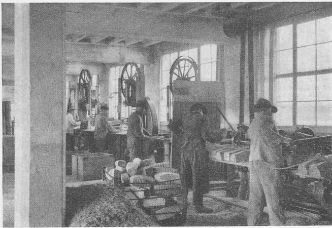
Abb. 6. Die Herstellung der Schuhleisten in Massenfaktikation an Bandsäge und Leistenfräse in der modernen Schuhfabrik.
