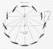
einer gewissen Schiffsgeschwindigkeit fortgeführten Propeller vollführt. Es ist dies dann der Fall, wenn im Grundriss die in den Drehpunkten der Flügel auf diese errichteten Senkrechten sich in einem Punkt N treffen (vergl. die hier nochmals reproduzierte Abbildung), und zwar ist die Exzentrizität ON proportional der Schiffsgeschwindigkeit. Bei Rotation des Propellers
