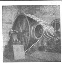
Antrieb eines Kompressors, 125 PS.
