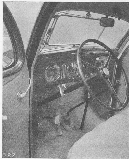
Abb. 14. Führersitz mit Betätigungsorganen.
