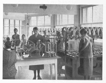
Abb. 8. Untersuchung auf Titer (Feinheit) des Fadens.
