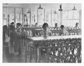
Abb. 7. Prüfung auf Windbarkeit (1. Stock).
