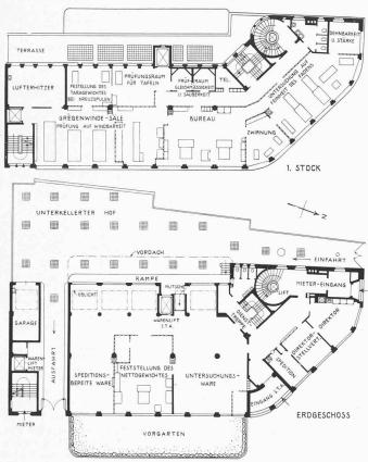
Abb. 1. Grundrisse des Gebäudes der Seidentrocknungsanstalt Zürich. Masstab 1:500.
