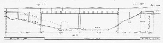
Abb. 2. Variante: Aareübergang in Stahlbau, Submissions-Projekt der SBB. — Ansicht 1:2500.
