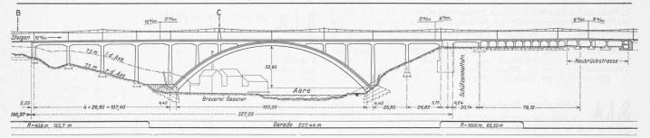
Abb. 1. Der grosse Aareübergang der neuen Linie Wylerfeld-Bern. — Eisenbeton- (bezw. Melan-) Submissions-Projekt der SBB. — 1:2500
