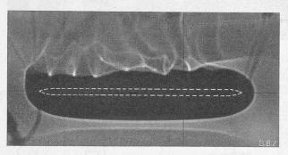
Abb. 6. Geheizte Platte, ohne Blende, wie Abb. 5 aber wagrecht. Platte von 12 cm Höhe, 25 cm Breite, 4 mm Dicke. Luft rd. 25°, Plattentemperatur zwischen 115 und 135°.
