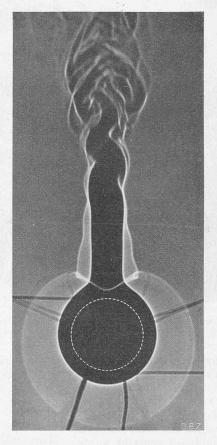
Abb. 3. Geheiztes Rohr, ohne Blende, von 50 mm  $\varnothing$  und 29 cm Länge.
