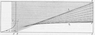
Abb. 2. Ablenkung der Lichtstrahlen über einer erhitzten Platte. AB Platte; ABCD erwärmte Zone; t Temperaturverlauf senkrecht zu AB; b<sub>1</sub> b<sub>2</sub> Brennlinien; E Schirm; EF Kernschatten; EG grösste Ablenkung proportional der Wärmeabgabe.
