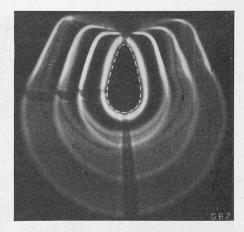
Abb. 7. Sechskantrohr bei verschiedenen Temperaturen, mit Blende. 20 mm Kantenlänge, 25 cm Länge, Raumtemp. 25°, Heiztemp. 75°, 118°. Rohrtemperaturen. 25 cm Länge.
