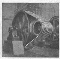
Antrieb eines Kompressors, 125 PS.
