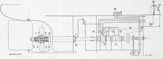
Abb. 4. Schematische Darstellung der Steuerung des Verstellpropellers beim Motorboot "Etzel". (Legende im Text.)
