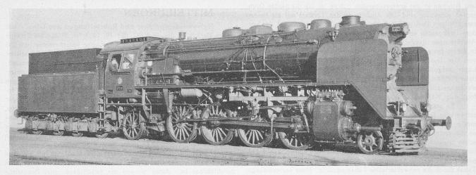
Abb. 1. Zweizylinder-Zwilling-Heissdampflokomotive für die Bulgarischen Staatsbahnen, gebaut von der Schweizer, Lokomotiv- und Maschinenfabrik Winterthur.
