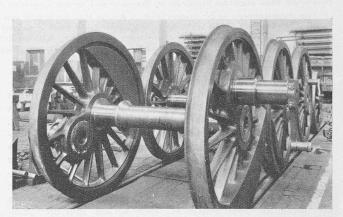
Abb. 2. Triebachsen der SLM-Winterthur-"Bulgarenlokomotive", ∅ 1650 mm.
